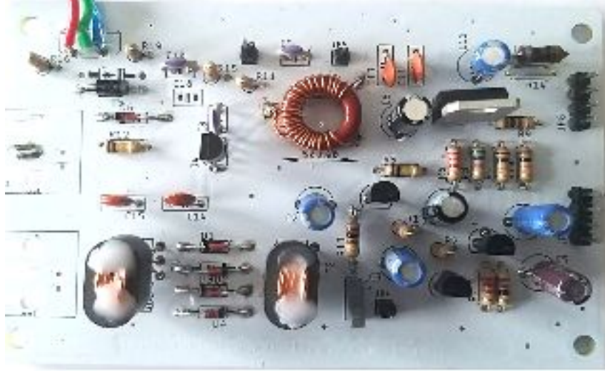
Resim. Domuzburnu toroidlerin PCB üzerine yerleşimi
